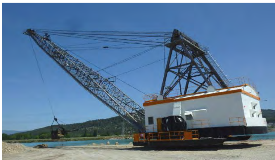
La pelle Chloée, en activité sur le site de Peyrolles-en-Provence (poids de 750 tonnes, débit de 800 t/h)
